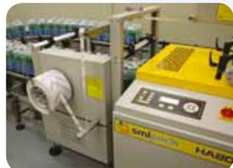
Enriqueciéndose con el nuevo opcional "asas en bobina", las colocadoras de asas SMIPACK se hacen aún más versátiles permitiendo así la utilización de una bobina de cinta de papel o de polipropileno. En este caso, la máquina efectúa el corte y la aplicación automática de la cinta de papel o polipropileno sobre la cinta adhesiva como alternativa a la utilización de la cartulina precortada o de la bobina de cinta con asa pre-introducida.
