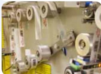
Enriquecendo-se com o novo opcional "alças na bobina", as aplicadoras de alças SMIPACK tornam-se ainda mais versáteis permitindo a utilização de bobina de fita de papel ou em polipropileno. Neste caso a máquina efetua o corte e a aplicação automática da fita de papel ou polipropileno na fita adesiva como alternativa para a utilização do cartão pré-cortado ou da bobina de fita pré-montada com alça.
